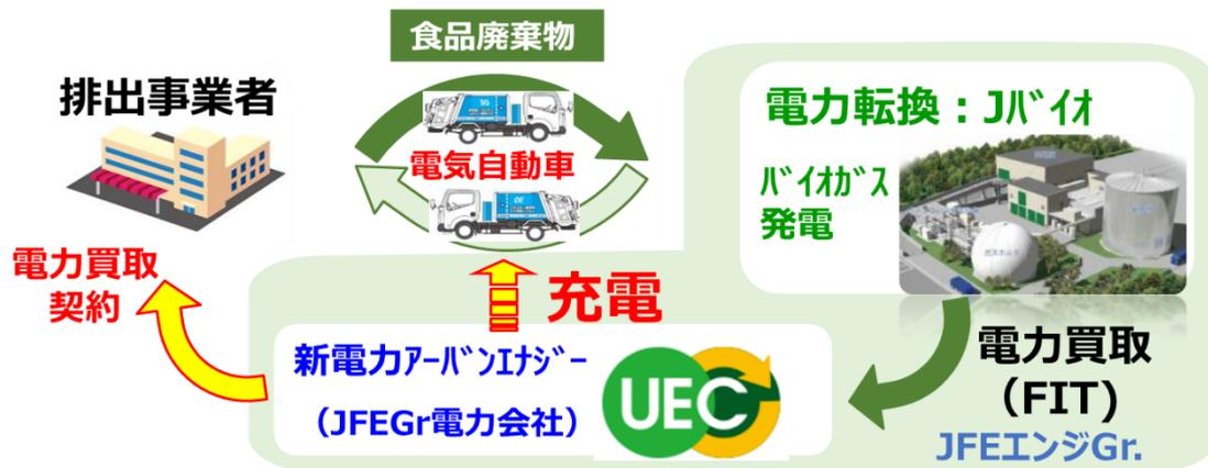
「創電割」に、J&T 環境保有の電池交換型 **EV パッカー車**を組み合わせた新プランを 19 年度に追加しました。EV パッカー車で廃棄物を収集し、リサイクル発電した電力は排出事業者へ「創電割」で供給されるとともに、EV パッカー車の充電電力にも利用されます。EV パッカー車による収集・運搬は **民間事業者国内初**で、収集運搬中の CO<sub>2</sub>排出ゼロ、化石燃料比 25%の低ランニングコストです。
